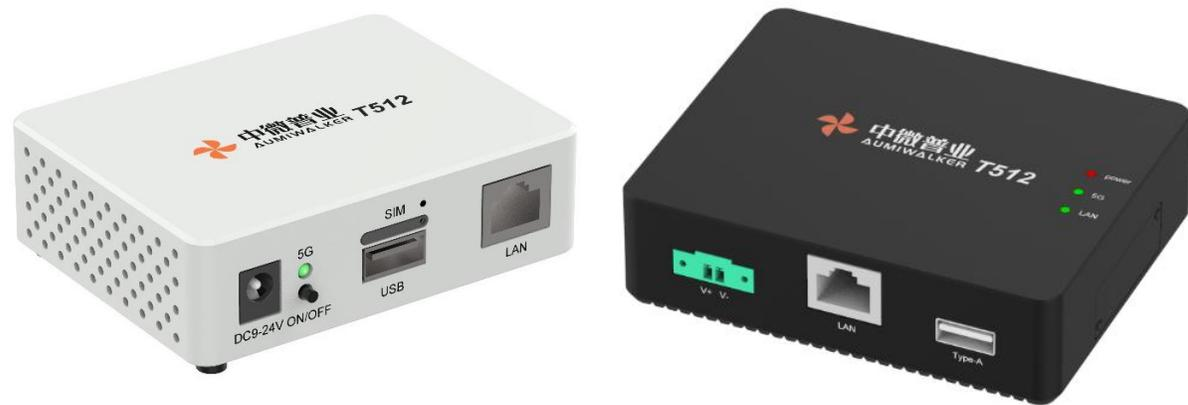
T512系列是一款工业级5G无线数据传输终端，全兼容 2G\3G\4G\5G。支持 1个GE口、1个USB口、单SIM卡。该系列提供丰富的安装方式、天线内置、体积小，易于快速集成到现有设备中实现5G功能，支持5G-LAN，支持L2TP、DMZ 以及OpenVPN等协议。
